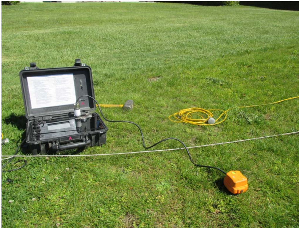
Foto 7: posizionamento e registrazione del rumore sismico ambientale mediante geofono triassiale
