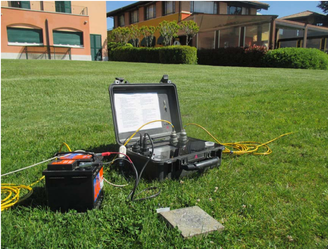
Foto 6: sismografo in posizione centrale
