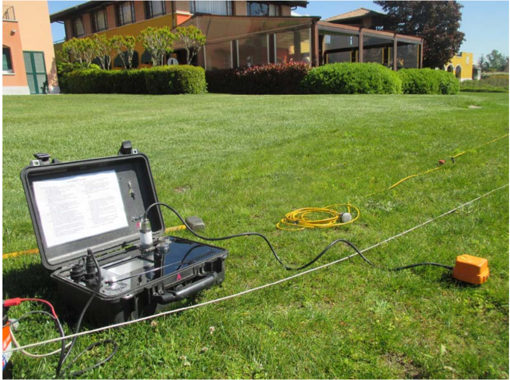
Foto 8: ubicazione del geofono triassiale nell'area Club House
